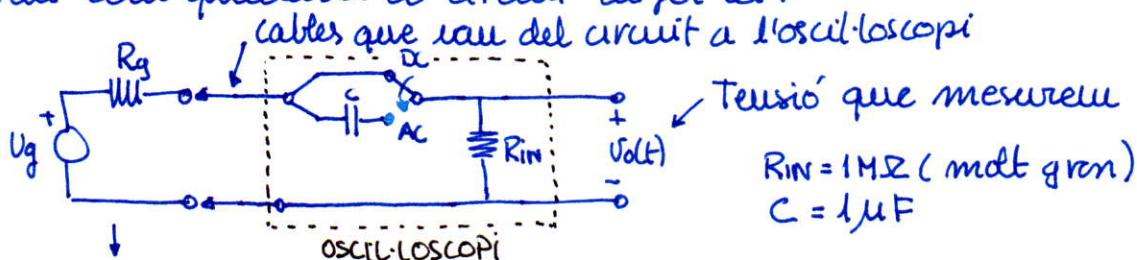
Equivalem l'haveren del circuit que volem mesurar.
