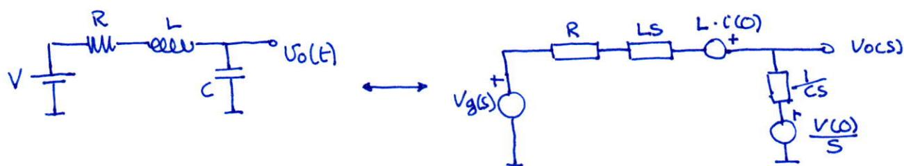
Si transformar el condensador hem posat la seva forma Thevenin. Si ho pensem a Norton, no tindrem s a les c.I.
