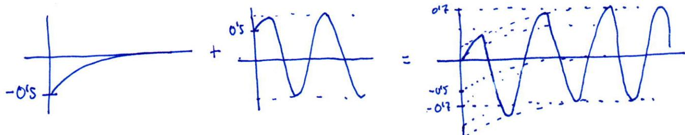
Vereu que un cop parat el transitori, aquest circuit oscilla. Si posem condicions inicials al condensador i desconnectem la font, tindriem un oscil·lador.
