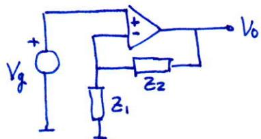
coneixem aquest circuit i sabem que és un amplificador no inversor. Per tant ja sabem que:
