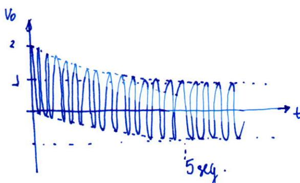
Al cap dels 5 seg veirem només el cosinus, sense la component continua. Per tant veiem que en posició AC, el condensador el que fa és treure la continua i visualitzar el senyal altern.
